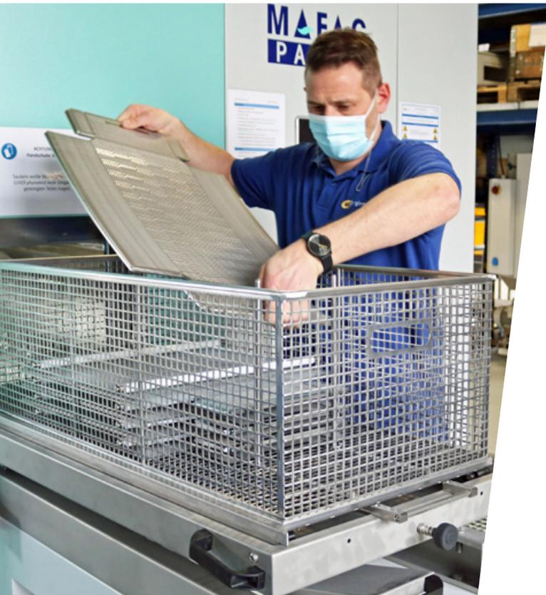
Die Edelstahlplatinen werden zu kleinen Paketchargen aufeinander geschichtet, was für die Reinigung und Trocknung eine besondere Herausforderung darstellt.
