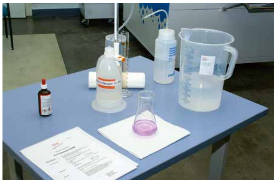
2 Testmethoden zur Überwachung der Badführung zeigen, wann ein Badwechsel nötig wird. Das richtige Nachdosieren sichert gleichbleibende Reinigungsergebnisse (© Hanser)
