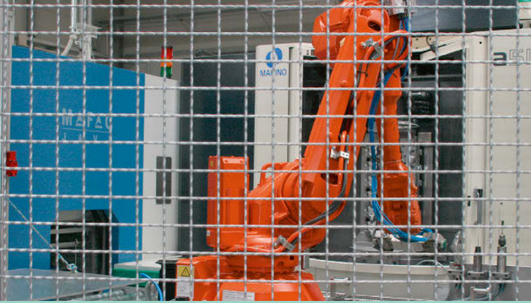
Die MAFAC Reinigungsanlage ist in die automatisierte Endfertigung der Ölpumpengehäuse integriert und direkt innerhalb der Roboterzelle installiert.
