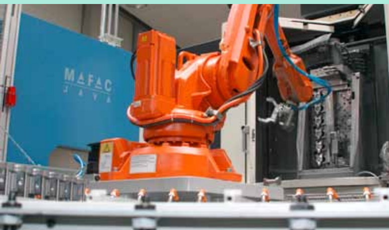
Die bei Haas installierte MAFAC JAVA wird von einem Roboter beschickt, der die mit Emulsion und Spänen verschmutzten Werkstücke aus der nebenstehenden Fertigungsmaschine entnimmt.
