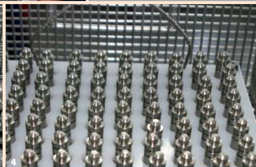
1 Die Elba von Mafac. 2 Drei Programme werden über das Bedienerkonzept »Maviatic« aktiviert. 3 Weniger empfindliche Werkstücke werden als Schüttgut eingelegt. 4 Empfindliche Teile werden in speziellen Beschickungsrahmen fixiert.
