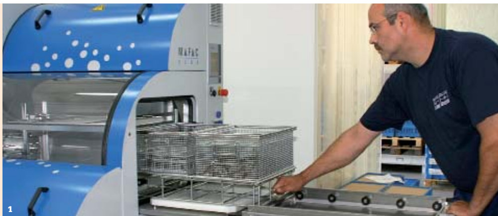
1 Die Elba von Mafac. 2 Drei Programme werden über das Bedienerkonzept »Maviatic« aktiviert. 3 Weniger empfindliche Werkstücke werden als Schüttgut eingelegt. 4 Empfindliche Teile werden in speziellen Beschickungsrahmen fixiert.
