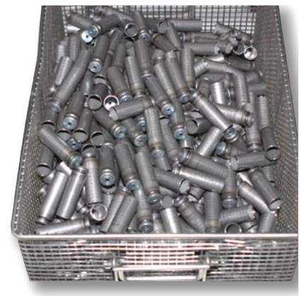
Die bei Voestalpine Rotec gefertigten Airbag-Generatoren sind auf Grund ihrer Geometrie schwierig zu reinigen.
