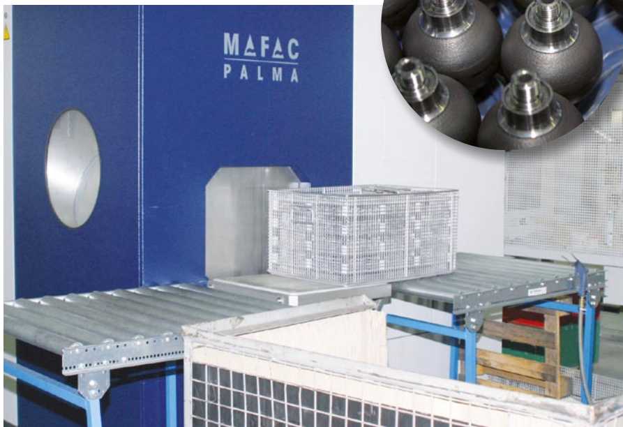
Zur Reinigung der Resonanzspeicher für Fahrzeuge mit Hydrauliksystemen, an die hohe Anforderungen gestellt werden, wurde die Palma bei Voestalpine Rotec installiert. Bilder: Mafac
