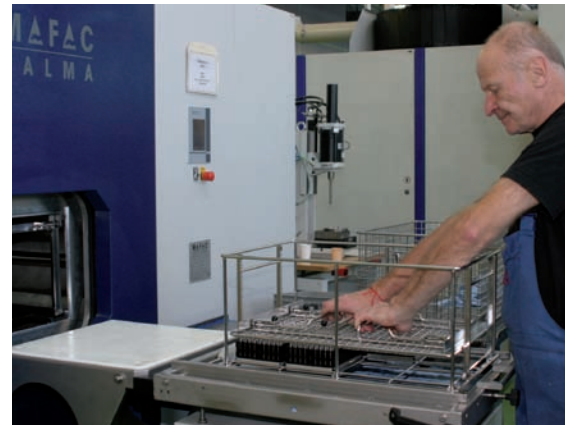
Beschicken der Reinigungsmaschine.
