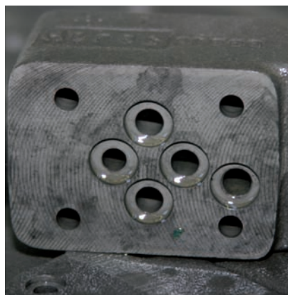
Bei Ventilgehäusen müssen nach dem Honen Öle aus den zum Teil tiefen Bohrungen entfernt werden.
