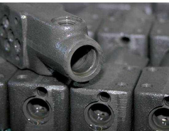
Manche der zu reinigenden Gehäuse können Rückstände wie beispielsweise Abschrecköle enthalten.
