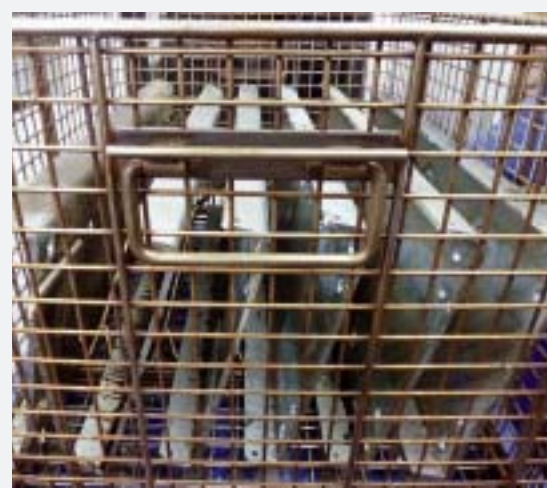
Verkleidungsteile aus Blech werden für die Reinigung in speziellen Beschickungsrahmen fixiert
