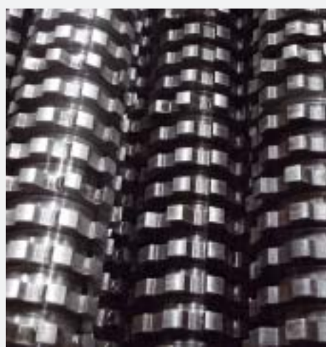
Crusherwalzen nach erfolgter Reinigung: Rückstände von Einweg-Gebinden und deren Inhalten werden zuverlässig entfernt
