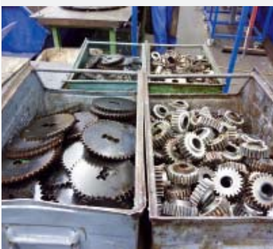
Die Crusherwalzen werden in Einzelteile zerlegt, bevor sie im Zwei-Bad-System Mafac Elba gereinigt werden
