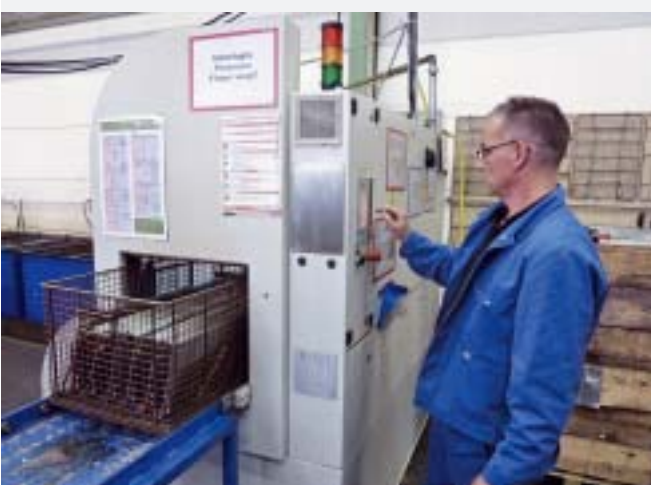
Die Elba hat bei HSM ihren festen Platz in der Abteilung Crusher-Demontage, wo wöchentlich ca. 120 Schneidwerke aufbereitet werden
