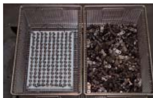
Empfindliche Teile mit hochkomplexen Geometrien werden für die Reinigung in speziellen Beschickungsrahmen fixiert, weniger empfindliche Werkstücke werden als Schüttgut eingelegt
