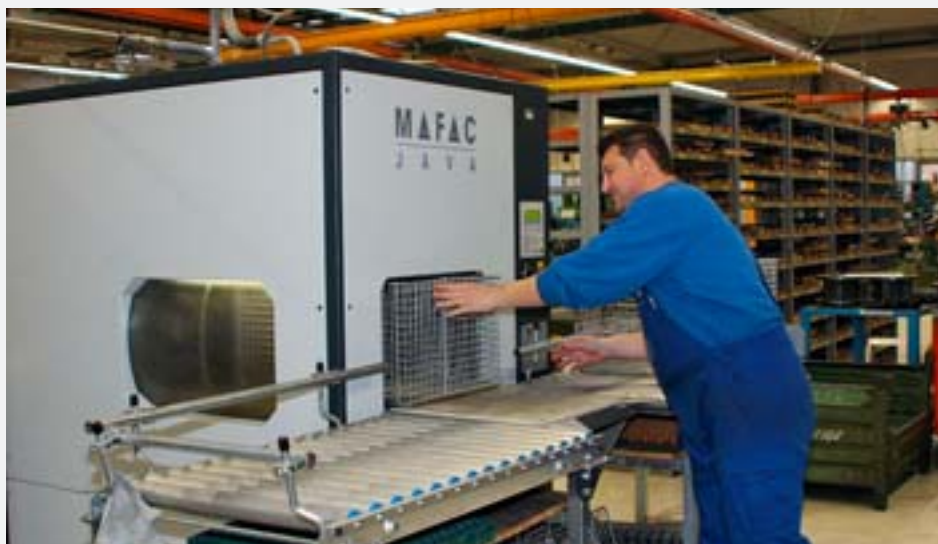
Die bei Stöber installierte Mafac Java ist mit einem Transportsystem aufgerüstet, das ebenfalls von Mafac projektiert wurde
