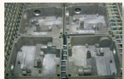
Bild 2 - 4: Überwiegend Aluminiumdruckgussteile für Reihengrenz-taster und für Gehäuse für Sicherheitsschalter werden in der bei Euchner installierten ELBA gereinigt
