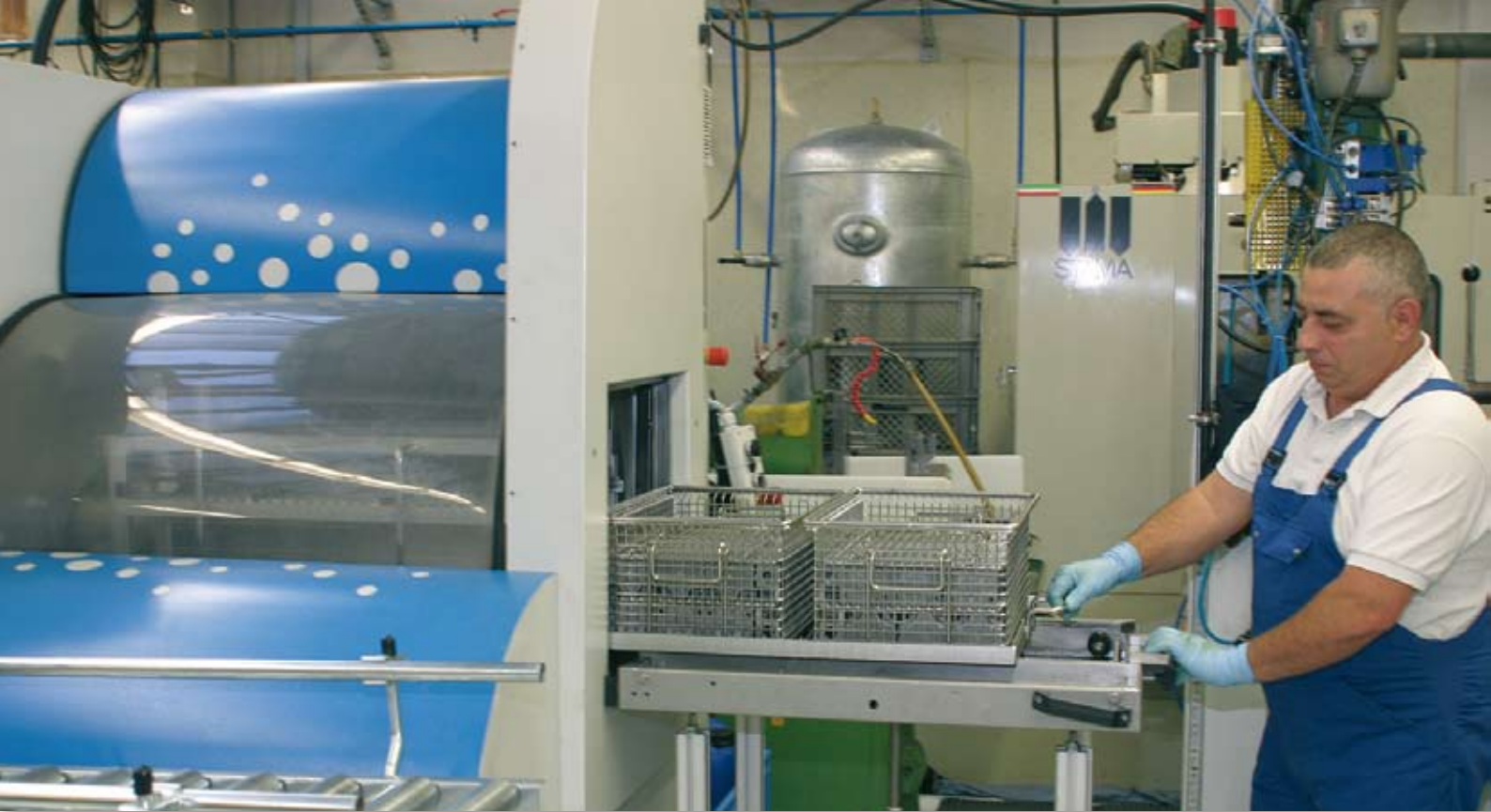
Bild 1: Beschickt wird die Reinigungsmaschine von unterschiedlichen Mitarbeitern, welche die eingespeicherten Programme über die MAVIATIC Touch-Panel-Steuerung aktivieren
