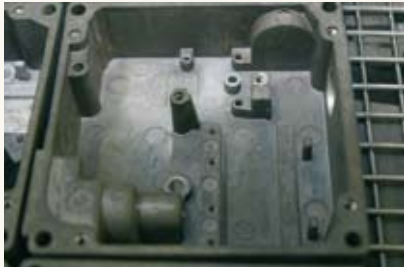
Bild 5 und 6: Die Aluminiumdruckgussteile, die bei Euchner in der ELBA gereinigt werden, haben keine sehr komplexen Geometrien, sind aber mit tiefen, zum Teil sehr kleinen Bohrungen versehen
