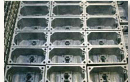
Bild 7 und 8: Da alle Werkstücke für die Reinigung in der ELBA fixiert werden, kann während der Nassphase die von den MAFAC-Technikern entwickelte und patentierte Verfahrenstechnik des Spritzreinigens in vollem Umfang genutzt werden
