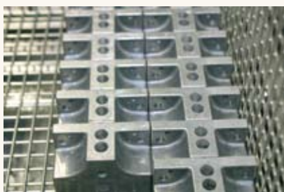
Bild 2 - 4: Überwiegend Aluminiumdruckgussteile für Reihengrenz-taster und für Gehäuse für Sicherheitsschalter werden in der bei Euchner installierten ELBA gereinigt
