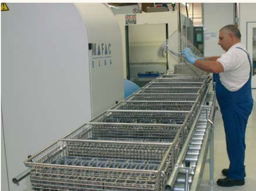
Bild 10: Als Sonderausstattung ist die bei Euchner installierte ELBA mit einem Transportsystem ausgerüstet (Werkbilder: MAFAC Ernst Schwarz Maschinenfabrik, Alpirsbach)
