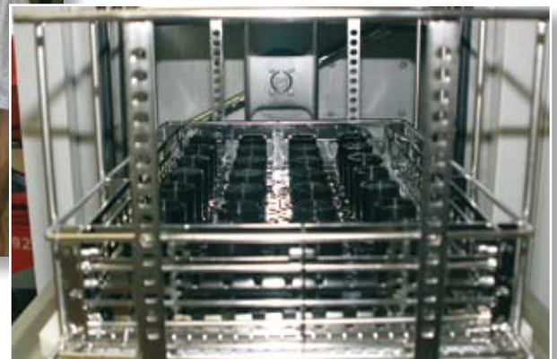
Bild 2 und 3: Für die Reinigung werden die AMF-Werkstücke in Spezialrahmen fixiert, so dass die Verfahrenstechnik des Spritzreinigens trotz der sehr empfindlichen, hochpräzisen Geometrie genutzt werden kann
