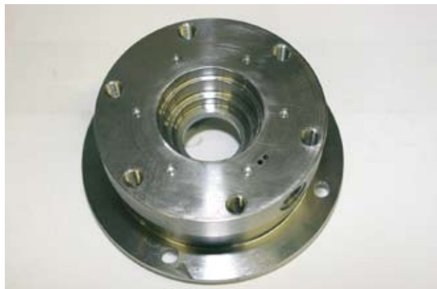
Bild 7 und 8: Die Verschmutzungen in Form von Spänen und Rostschutzöl werden dank der speziellen Verfahrenstechnologie der KEA mit sehr gutem Ergebnis aus den Bohrungen, Windungen und Sacklöchern der Pumpengehäuse (links) und -flansche (rechts) abgereinigt (Werkbilder: MAFAC Ernst Schwarz Maschinenfabrik GmbH & Co. KG, Alpirsbach)
