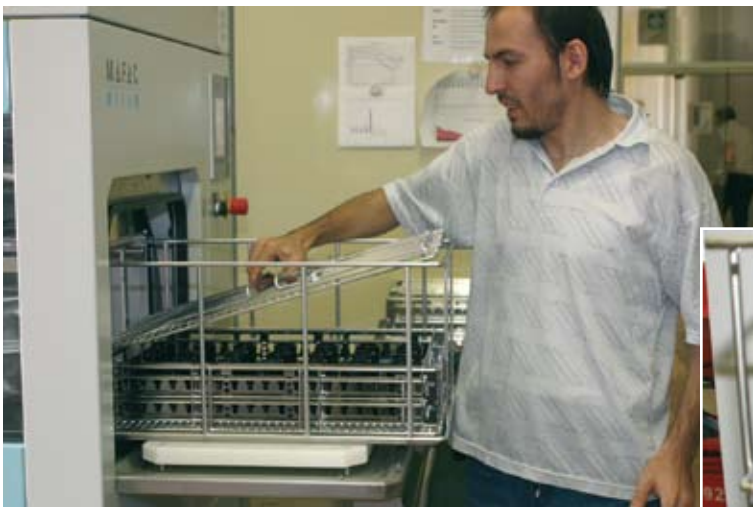
Bild 2 und 3: Für die Reinigung werden die AMF-Werkstücke in Spezialrahmen fixiert, so dass die Verfahrenstechnik des Spritzreinigens trotz der sehr empfindlichen, hochpräzisen Geometrie genutzt werden kann
