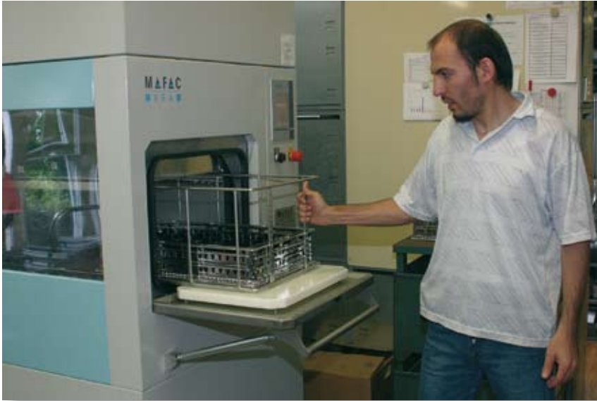
Bild 1: Die Reinigungsmaschine KEA ist bei AMF in der Montageabteilung für Hydraulikelemente installiert und wird von allen dort tätigen Mitarbeitern beschickt
