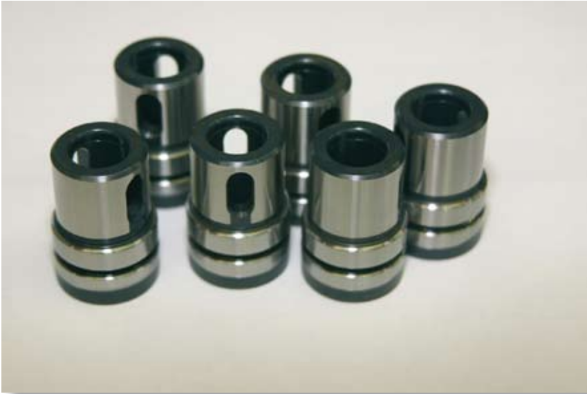
Bild 5 und 6: Für die Zwischenlagerung wurden die Deckel, Kolben (Bild oben), Pumpengehäuse und Verteilerblöck (Bild unten) mit Rostschutzöl versehen, das während der Reinigung in der KEA abgereinigt wird
