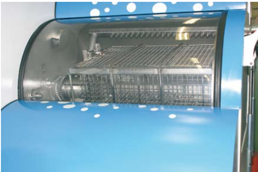
Bild 7: Auch während der Trocknungsphase rotiert das Korbaufnahmesystem gegenläufig zum rotierenden Blassystem (Werkbilder: Ernst Schwarz Maschinenfabrik GmbH & Co. KG, Alpirsbach)
