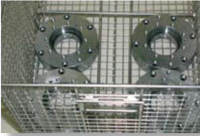
Bild 4 und 5: Für die Reinigung in der ELBA werden die Flansche (Bild 4) und die Gehäuse (Bild 5) mit Spezialrahmen im Korbaufnahmesystem fixiert, so dass die Verfahrenstechnik des Spritzreinigens in vollem Umfang genutzt und ein optimales Reinigungsergebnis erzielt werden kann
