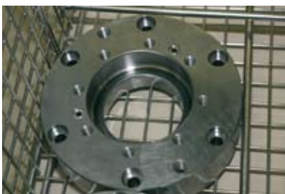
Bild 1 bis 3: Sowohl die Flansche (Bild 1) als auch die Gehäuse (Bild 2, 3), die bei Fibro in der ELBA gereinigt werden, weisen komplexe Geometrien mit vielen tiefen, z.T. engen Bohrungen auf
