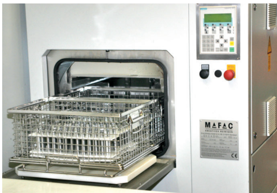
1 Seit Herbst 2007 ist die Ein-Bad-Reinigungsmaschine »KEA« der Firma Mafac in der Fertigung von Heppler installiert
