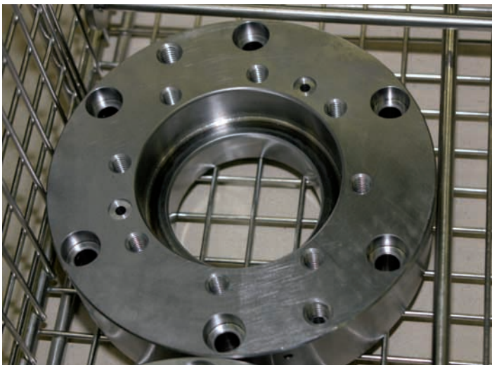
Sowohl die zu reinigenden Flansche als auch die Gehäuse weisen komplexe Geometrien mit vielen tiefen und zum Teil engen Bohrungen auf.
