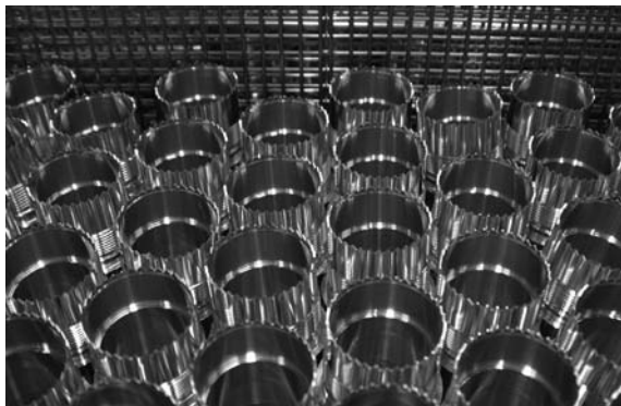
Gereinigt werden Steckgehäuse mit 2,5 bis 63 mm Durchmesser und 20,8 bis 140 mm Länge
