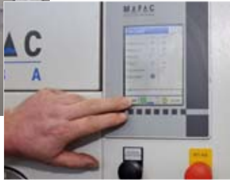
Die bei Braun installierte Elba ist mit der Maviatic, dem neuesten Touch-Screen-Bedienersystem der Firma Mafac ausgestattet, über das die Programme problemlos eingespeichert und aktiviert werden
