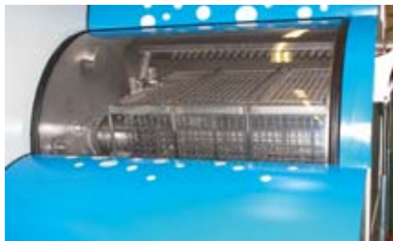
Auch während der Trocknungsphase rotiert das Korbaufnahmesystem gegenläufig zum rotierenden Blastsystem
