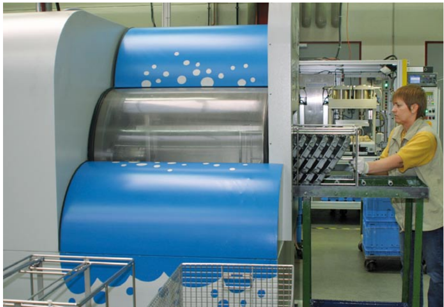
Die Reinigungsmaschine bei Amann Druckguss ist in eine Fertigungsstraße für die Herstellung von Ölwanne aus Aluminiumguss integriert
