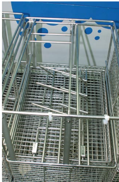
Für die Reinigung werden die Ölwanne in speziellen Beschickungssystemen fixiert und mit einem Deckel versehen. Diese bieten Platz für drei Ober- oder sechs Unterteile.
