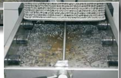
Bild 1-3: Die bei Kipp gefertigten Drehteile weisen Rückstände in Form von Ölen und Spänen auf, die in der ELBA abgereinigt werden müssen
