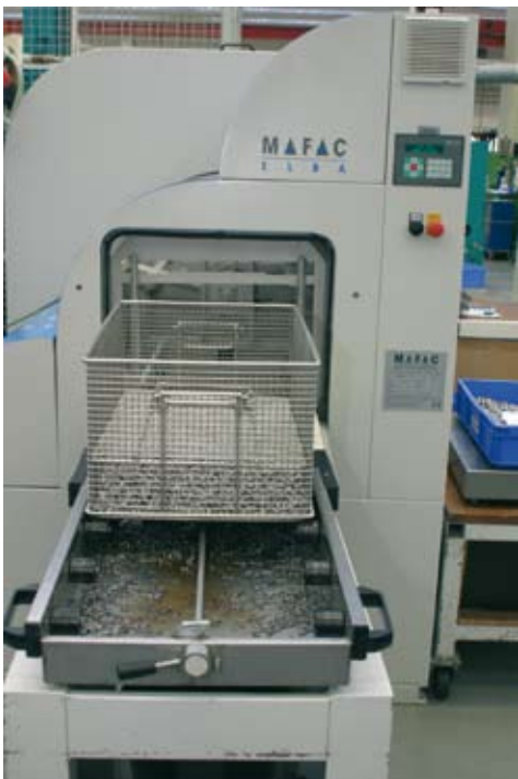
Bild 1-3: Die bei Kipp gefertigten Drehteile weisen Rückstände in Form von Ölen und Spänen auf, die in der ELBA abgereinigt werden müssen
