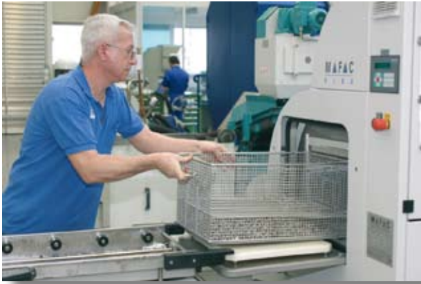
Bild 4: Die ELBA ist bei Kipp zentral in der Dreherei installiert. Zu 90 % werden Drehteile in der Maschine gereinigt (Werkbilder: MAFAC Ernst Schwarz Maschinenfabrik GmbH & Co. KG, Alpirsbach)
