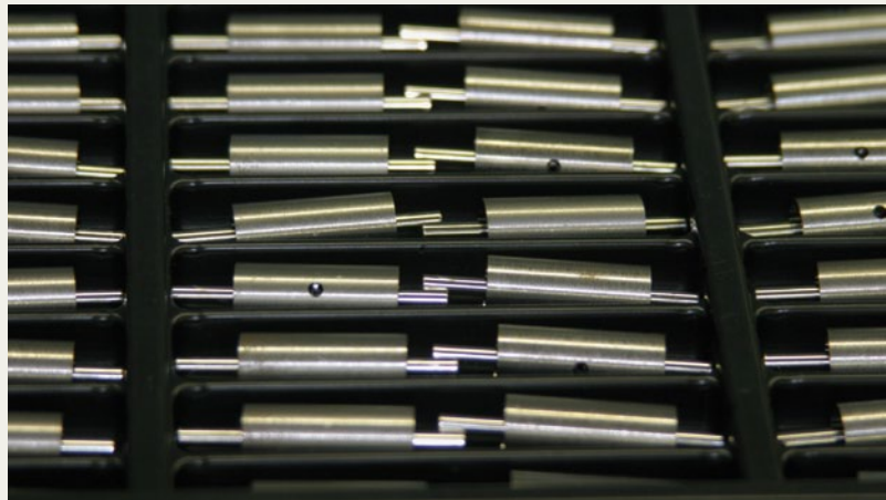
Ein Großteil der Werkstücke weist tiefe Sacklochbohrungen mit einem Durchmesser zwischen 2 und 5 mm auf
