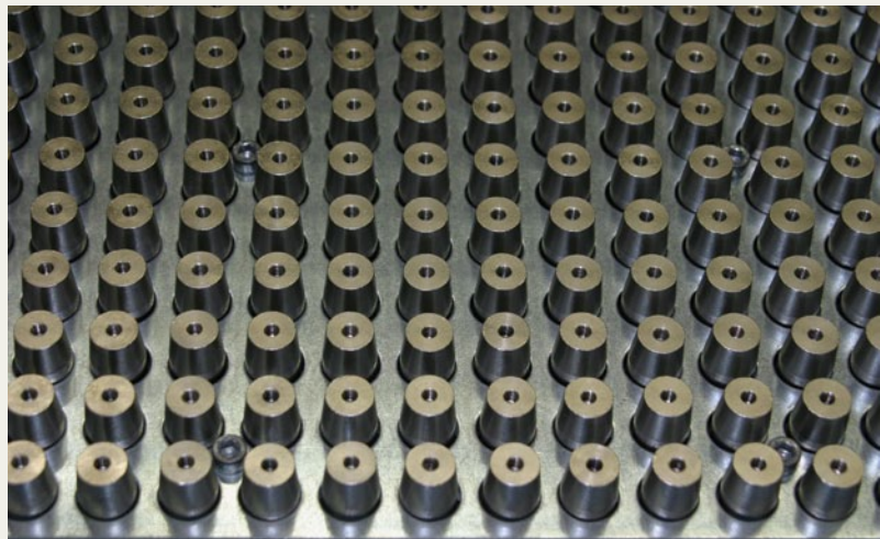
Aufgrund der komplexen Geometrie mit Längs- und Querbohrungen werden die Teile in Spezialträger eingelegt
