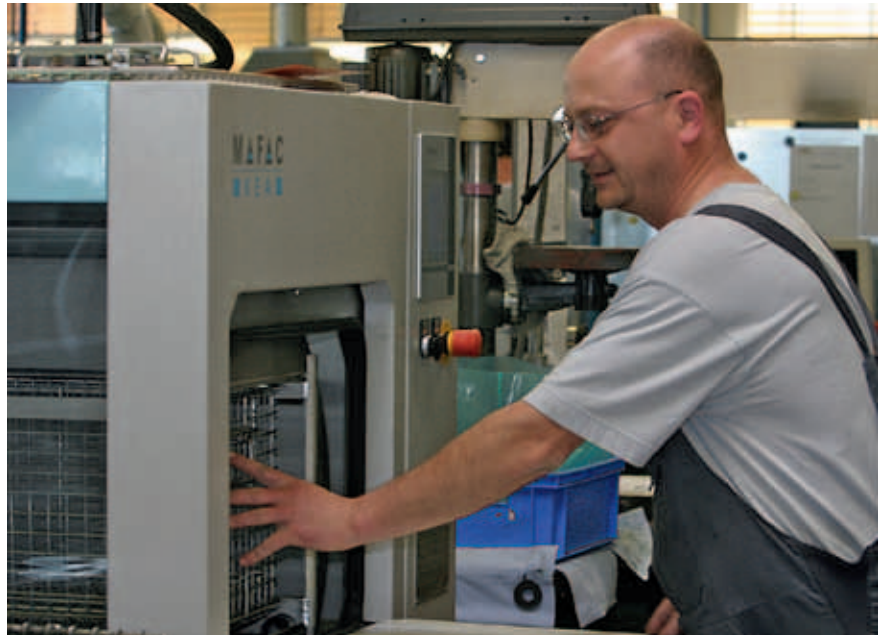
Die kompakte Bauweise der Reinigungsanlage ermöglicht nachträglich die Integration in bestehende Produktionsanlagen
