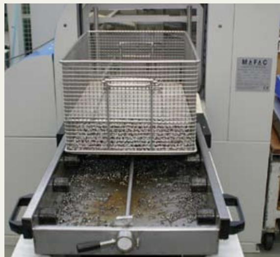
90 Prozent des Reinigungsguts sind Drehteile, die zum Teil sehr stark mit Öl und Spänen verschmutzt sind ▶
