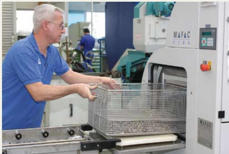
▲ Die Reinigungsanlage ist bei Kipp zentral in der Dreherei installiert und wird von einem für die Reinigung zuständigen Mitarbeiter besetzt
