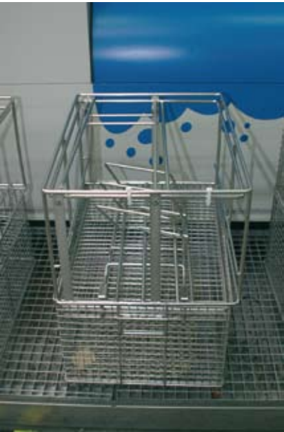
Bild 2 und 3: Für die Reinigung werden die Ölwanne in speziellen Korbaufnahmesystemen fixiert und mit einem Deckel versehen. Diese bieten Platz für drei Oberteile oder sechs Unterteile
