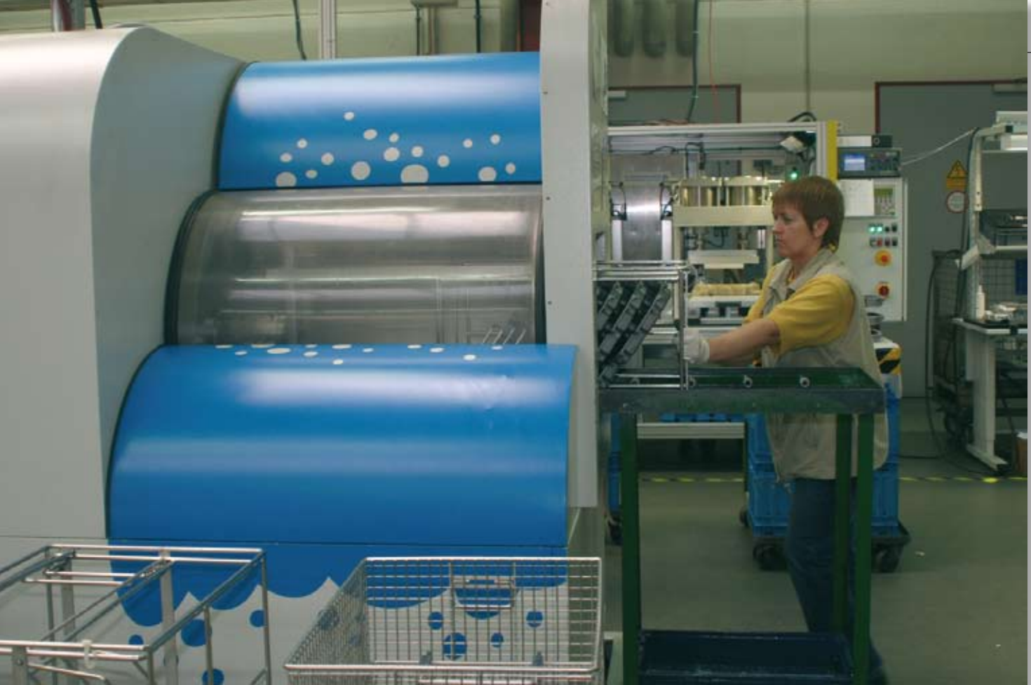
Bild 1: Die Reinigungsmaschine ELBA ist bei der Firma Amann Druckguss in eine Fertigungsstraße für die Herstellung von Ölwannen aus Aluminiumguss integriert
